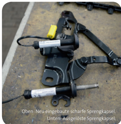
So sieht ein ausgelöster Fussgängerschutz am BMW 525 aus.
